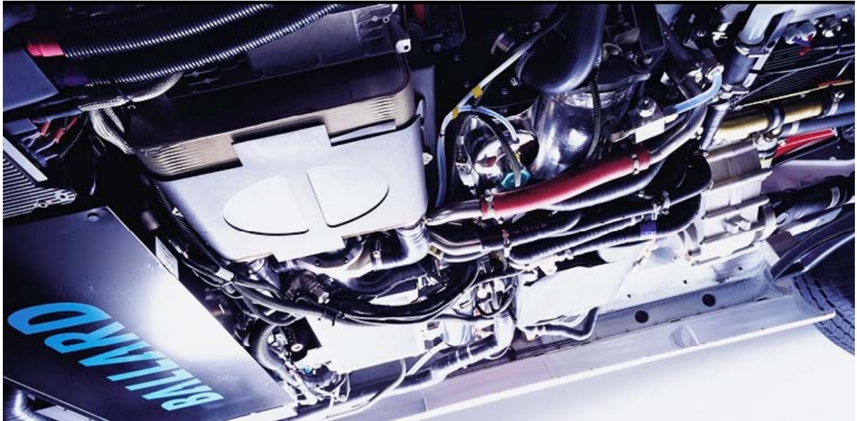
Abbildung 15: Brennstoffzellensystem im Fahrzeugboden des Mercedes Sprinter
