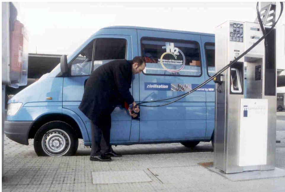
Abbildung 13: Fahrzeug an der H 2 -Tankstelle
