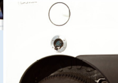
Für den Wasserstoff gibt es einen Tankstutzen extra.
