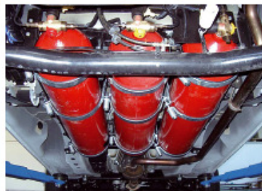
Anordnung der Wasserstoff-Gastanks unter dem Fahrzeug – kein Verlust an Laderaum.
